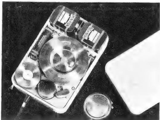
Batteriebetriebenes Taschen-Drahtongerät „Minifon“ der Firma Monske & Co.
