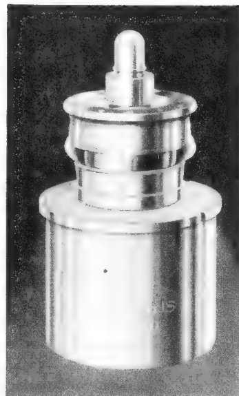
Luftgekühlte Fernseh-Sendetriode RS 1011 L von Siemens. Sämtliche Elektrodenanschlüsse sind zur Verwendung in Gitterbasisschaltungen und für den Anschluß an Rohrleitungssysteme konzentrisch ausgeführt
